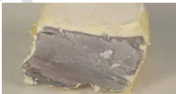
شکل ۶- سدیم در مجاورت هوا به آرامی به سدیم اکسید تبدیل می‌شود.
