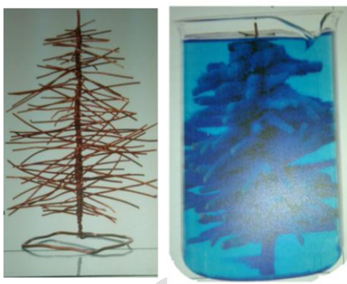
شکل ۲ آ. با قرار دادن سیم مسی (درختچه مسی) در محلول نقره نیترات رنگ محلول تغییر می‌کند.
