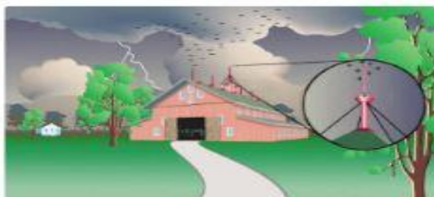
شکل ۳-۷- برق گیر ، ساختمان را از خطر برخورد آذرخش حفظ می کند.
